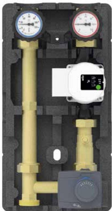
Für die Ersteinstallation lässt sich der Kv-Wert mit einem Schlitz-Schraubendreher an der Mischer-Rückseite einstellen.
