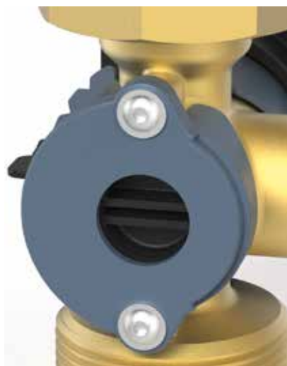
Für die Ersteinstallation lässt sich der Kv-Wert mit einem Schlitz-Schraubendreher an der Mischer-Rückseite einstellen.
